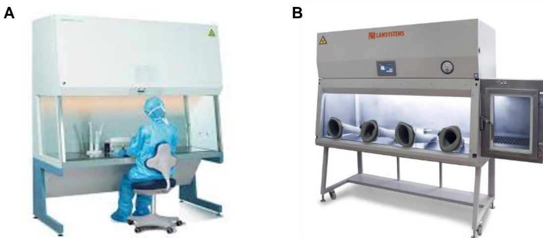
Figura 12 - Cabine de segurança biológica classe II (A) e classe III (B)
